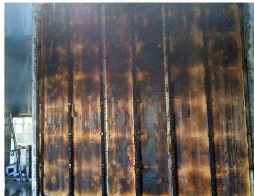
試験後(外壁側)の窯業系サイディング除去後の状況
